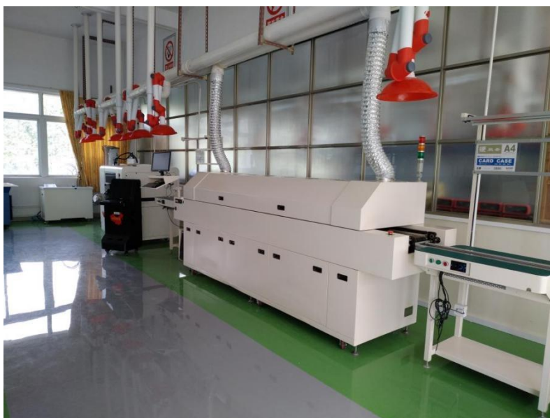
图 3 电子工艺实训室 SMT 设备
